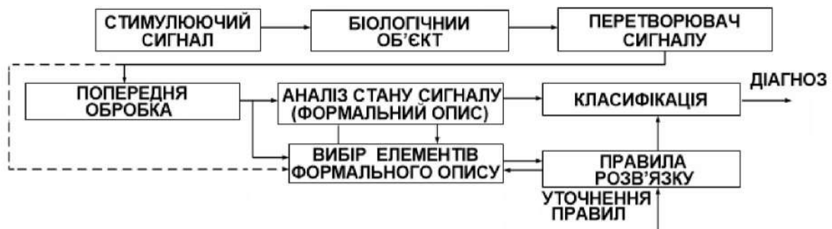
Рисунок 5 – Схема процесу вимірювання біологічних сигналів
