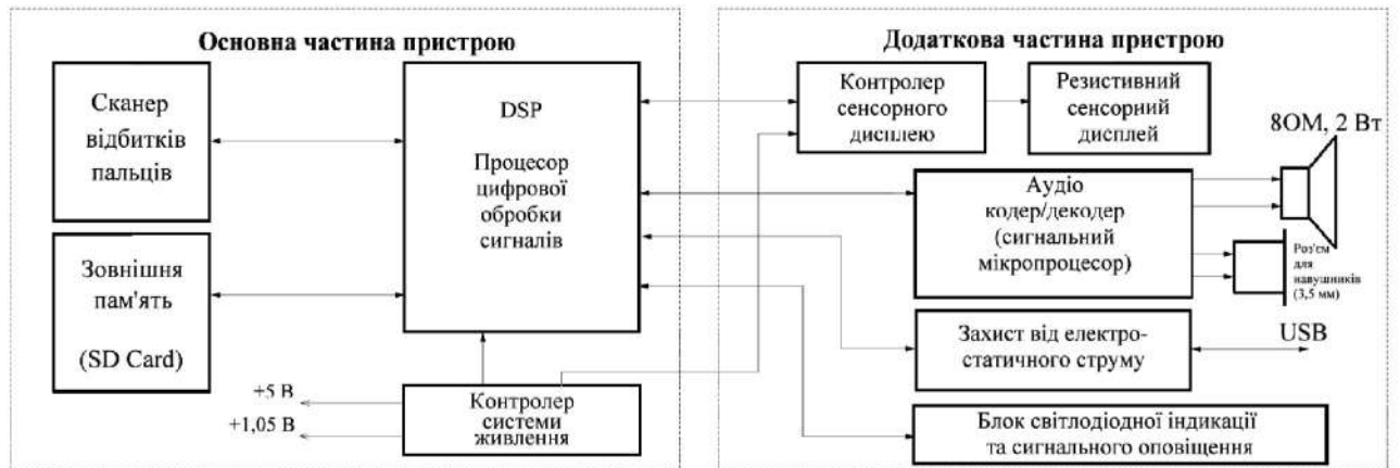
Рисунок 3 - Структурна схема мікропроцесорного пристрою автентифікації персони за біометричними даними
