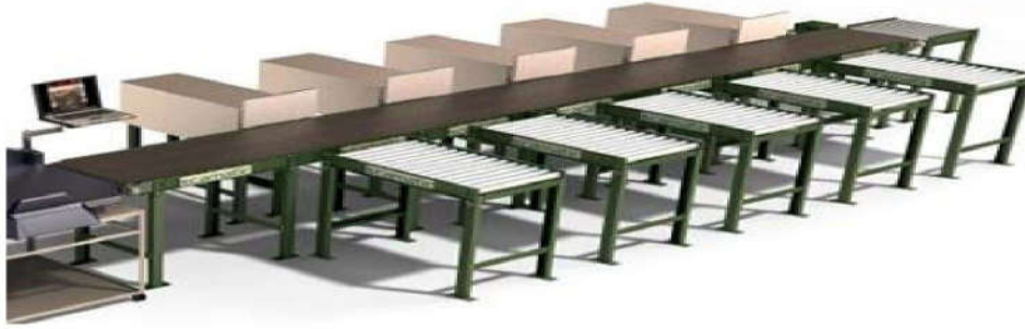
Рисунок 3 - АСУ з використанням конвеєра та штовхачів
