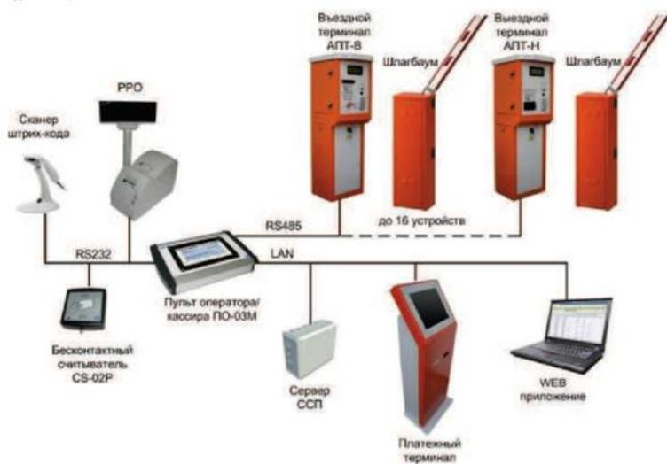
Рисунок 4 - Схема організації зв'язків між елементами системи платного паркування
