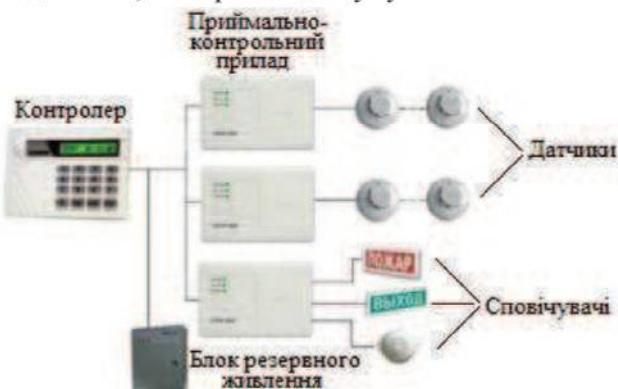
Рисунок 1 – Схема автоматизованої системи охоронно-пожежної сигналізації
