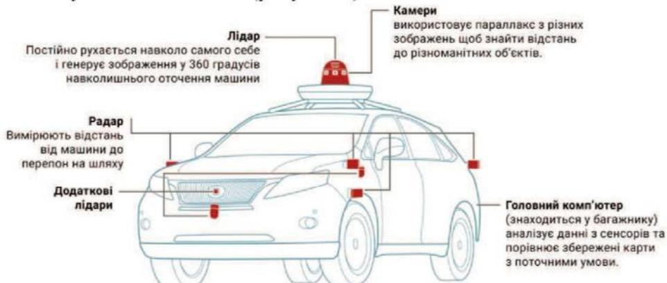
Рисунок 1 – Розміщення давачів на автономно керованому автомобілі
