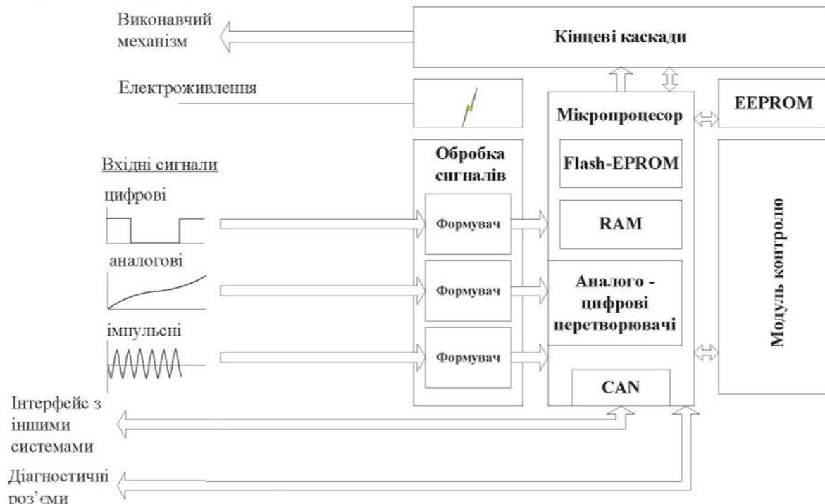
Рисунок 3 – Функціональна схема спеціалізованої системи
