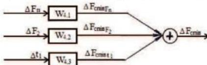
Рисунок 7 - Структурна схема по каналу регулювання співвідношення «газ-повітря»
