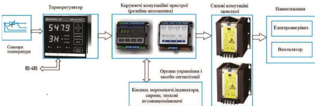
Рисунок 3 - Структурна схема АСУ ТП з реалізацією одноканального двохпозиційного регулювання температури
