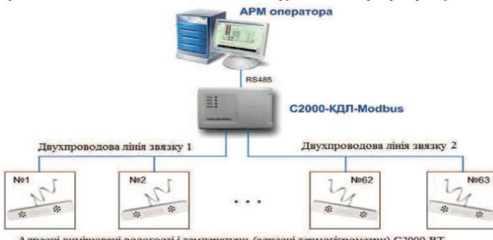
Рисунок 1 – Архітектура автоматизованій системи моніторингу температури і вологості в приміщенні
