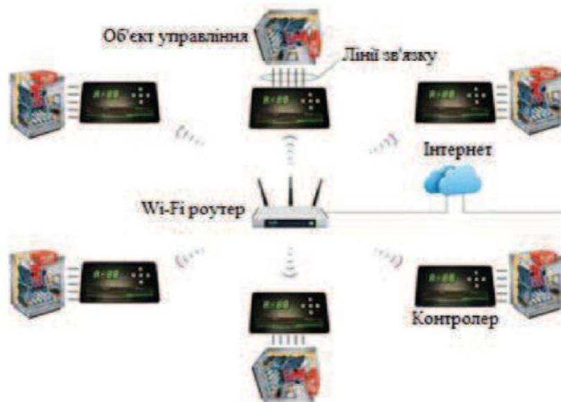
Рисунок 4 – Схема системи розумного будинку без диспетчерської станції
