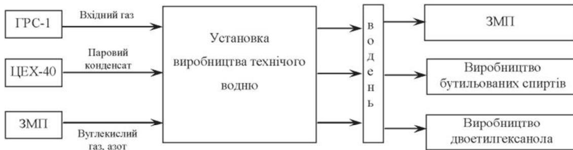
Рисунок 1 – Виробничі зв'язки установки виробництва водню
